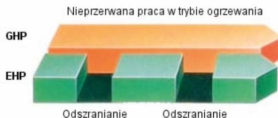
Rys. 5. Różnica w ciągłości działania gazowych (GHP) i elektrycznych (EHP) pomp ciepła w trybie chłodzenia. W układzie EHP widoczne są przerwy w pracy potrzebne na odszranianie układu.
